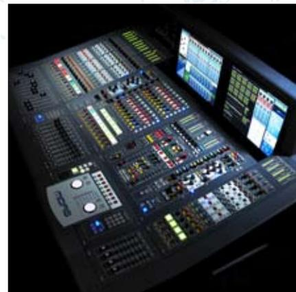
Los efectos y algoritmos que el dispositivo permite manipular son de manejo ágil gracias al procesamiento de estos en *Linux*. El resultado es el despliegue de una interfaz que simplifica el método de operación para los ingenieros de audio.
